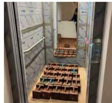
Probefahrt vor der Inbetriebnahme mit der Maximalbelastung (Foto: F. Klotz)
